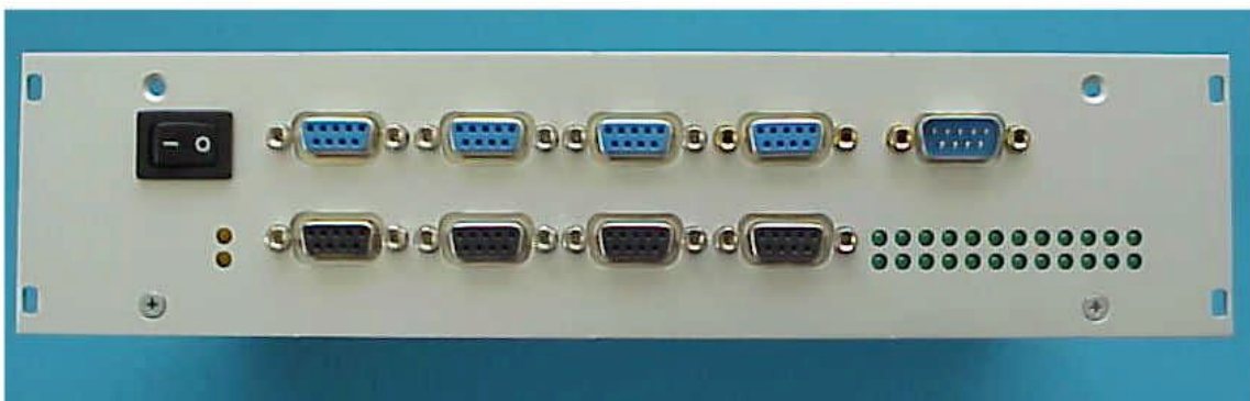
Frontansicht komplett (C-Version): Ein/Aus, V.24 Schnittstelle 1 – 9, Status LED
