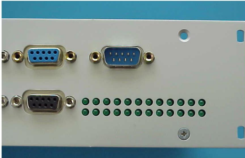
Frontansicht: Status LED für V.24 Schnittstelle 1 –24 (Version 2.2X)
