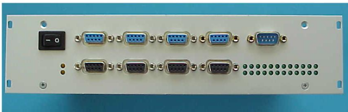
Frontansicht komplett (Version 2.2X): Ein/Aus, V.24 Schnittstelle 1 – 9, Status LED
