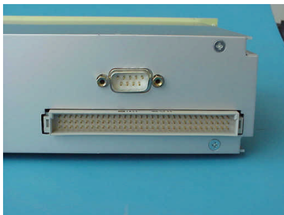
Rückansicht: Anschluß für Stromversorgung und V.24 Schnittstelle 9 –16
