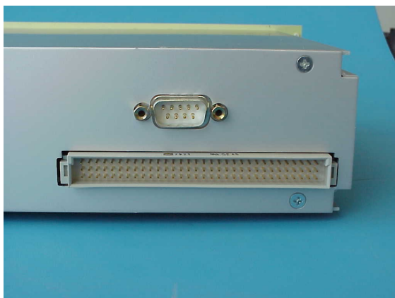
Rückansicht: Anschluß für Stromversorgung und V.24 Schnittstelle 9 –16
