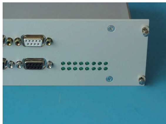
Frontansicht: Status LED V.24 Schnittstelle 1 –16 (B-Version)
