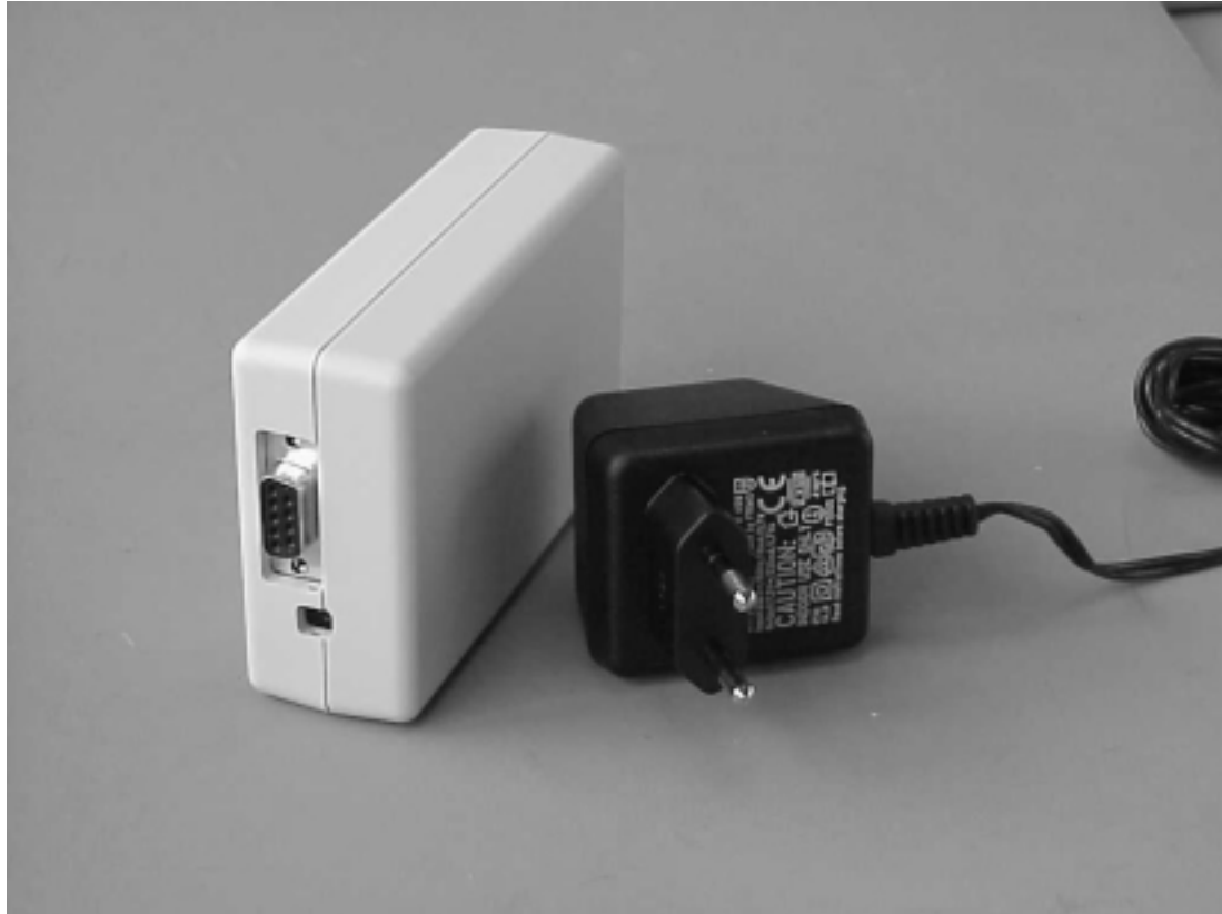
UNIPROG SET: Grundeinheit mit Steckernetzteil, PC und Stromversorgungsanschluß
