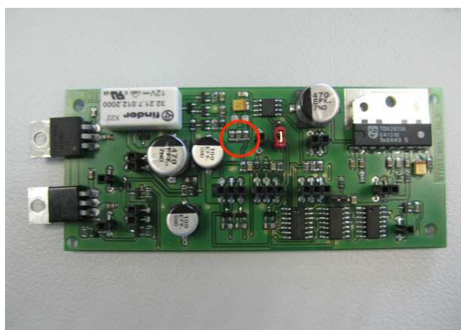
Bild: Lage der zeitbestimmenden Widerstände (3x 10M Ohm)
