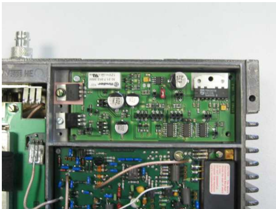
Bild: FUG 8 nach Einbau der Baugruppe
