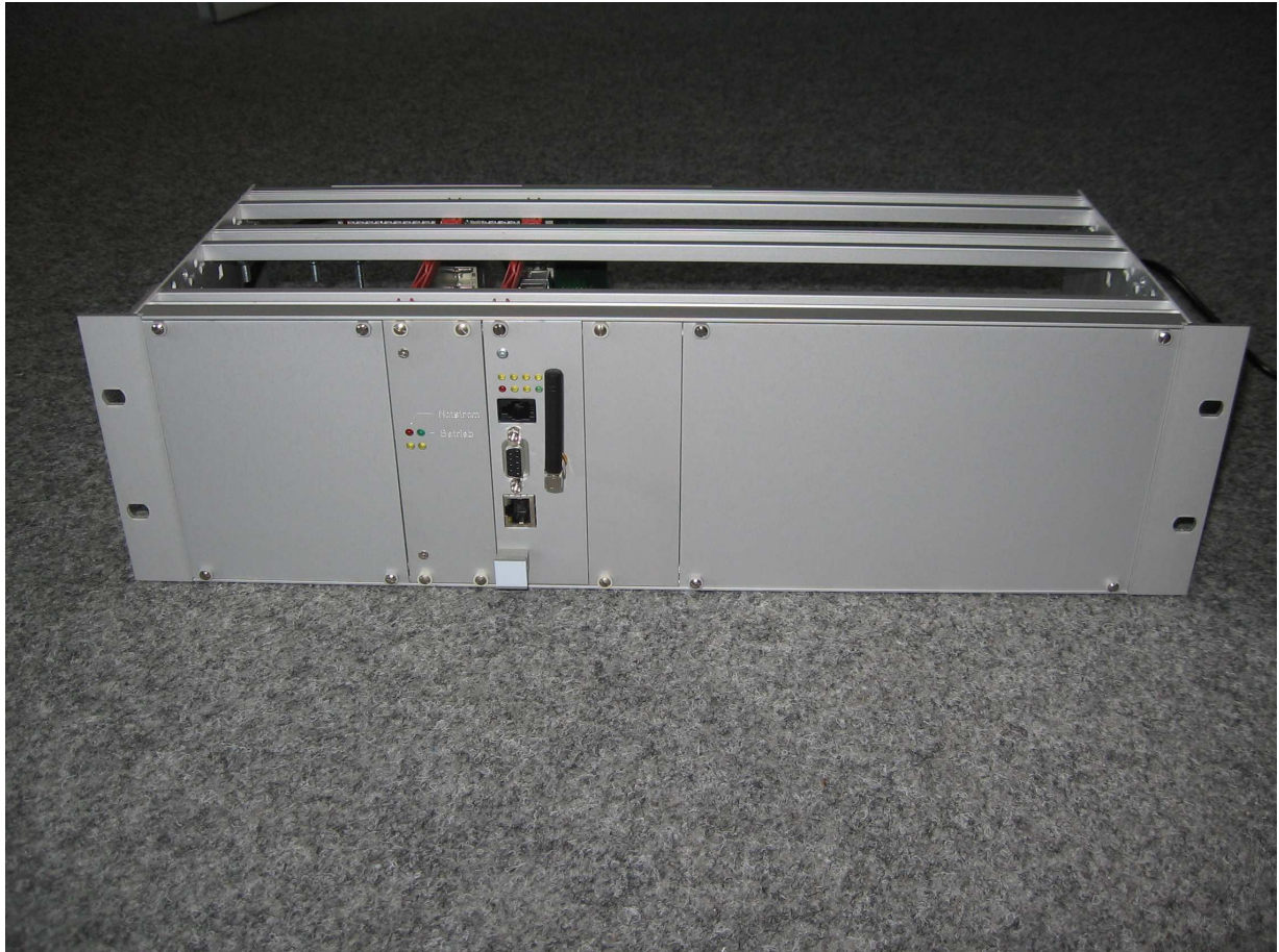
Aufbau in einem 19" 3HE Baugruppenträger
