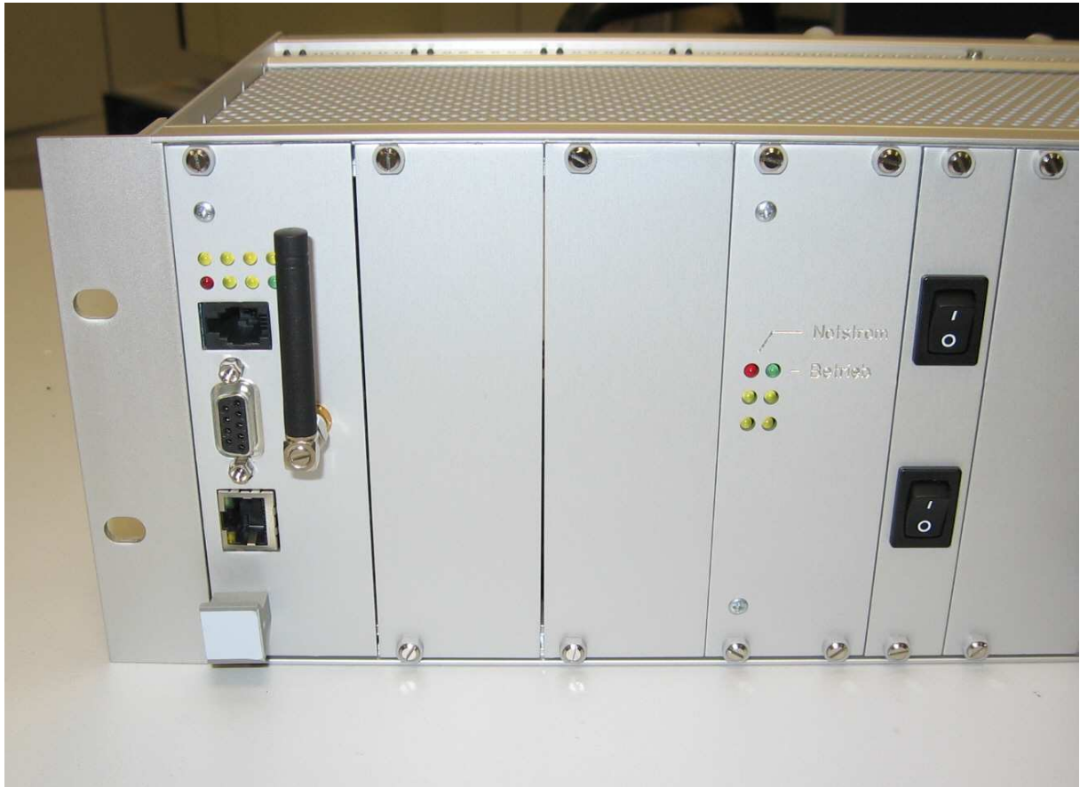
Option GSM Zubringer (links) und Notstrom (rechts)
